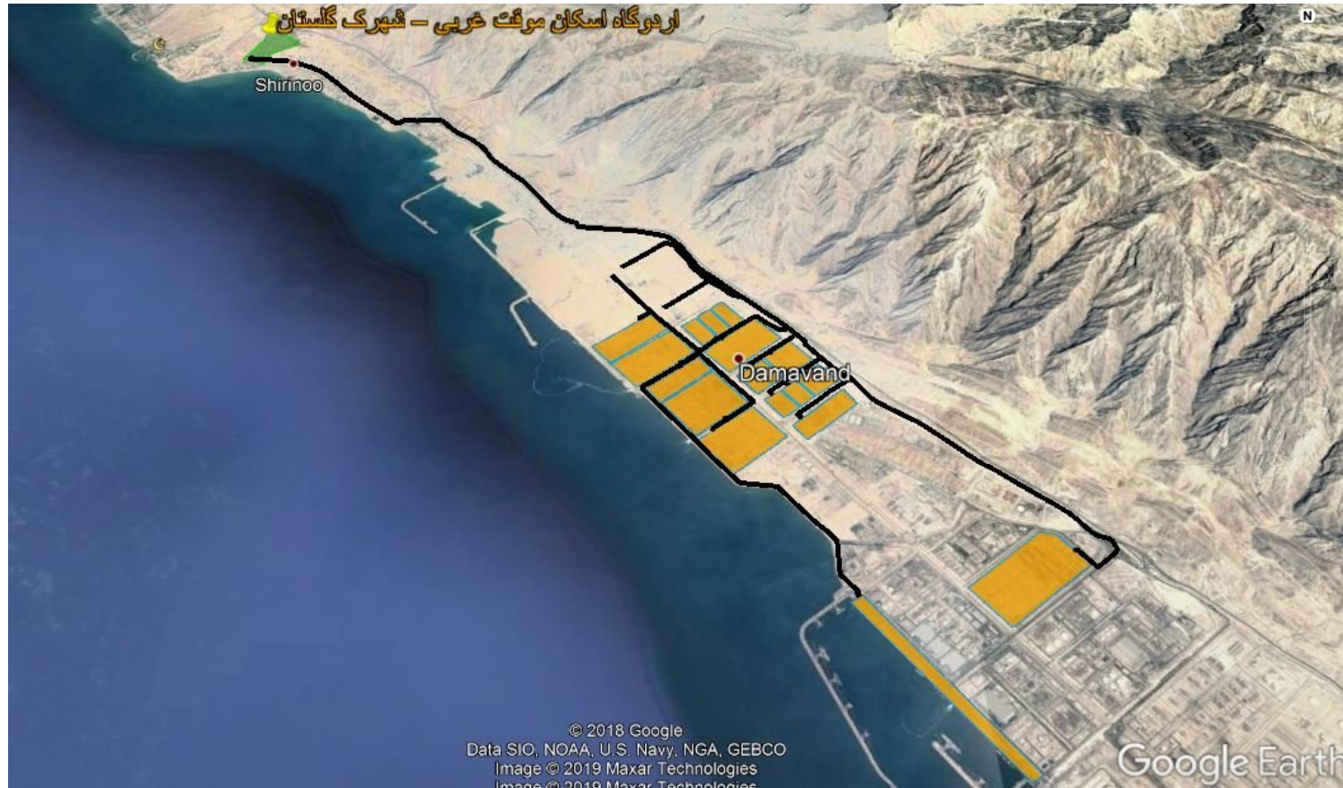
شکل ۱۳- نمایش مسیرهای تخلیه اضطراری پتروشیمی های فاز ۱ و ۲ به سمت شهرک گلستان (نمای دور)
