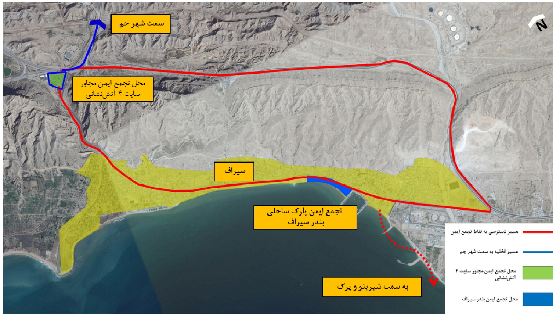
شکل ۱۲- نمایش مسیرهای تخلیه اضطراری شهر سیراف، پارس ۲
