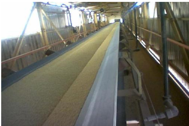
شکل ۳ - نمای داخلی از تسمه نقاله پوشیده جهت انتقال گوگرد
