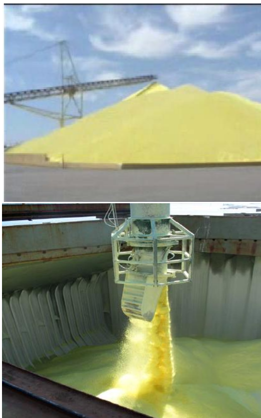
شکل ۴- فاصله تخلیه در انبار روباز (بالا) و کشتی (پایین)
