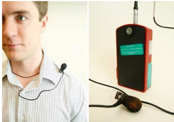
شکل ۲. موقعیت مناسب میکروفون برای دوزیمتری صدا
